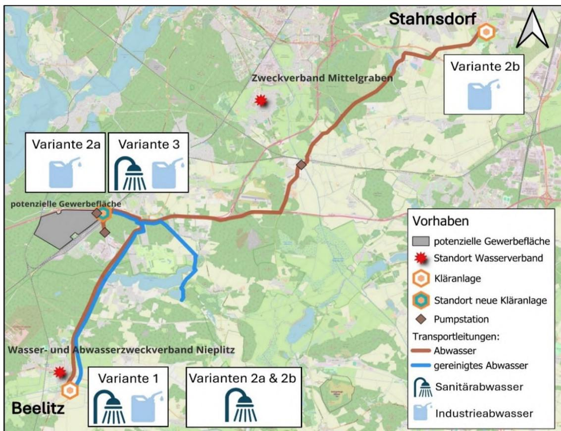
Abbildung 4: Trassenvarianten für Schmutzwasserentsorgung des Industriegebietes
