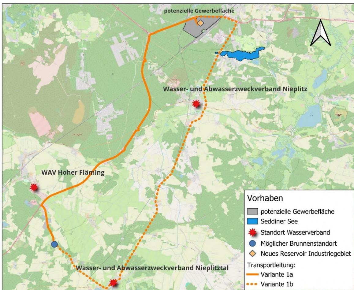
**Abbildung 3: Mögliche Trassenvarianten für die Wasserversorgung des Industriegebietes**
