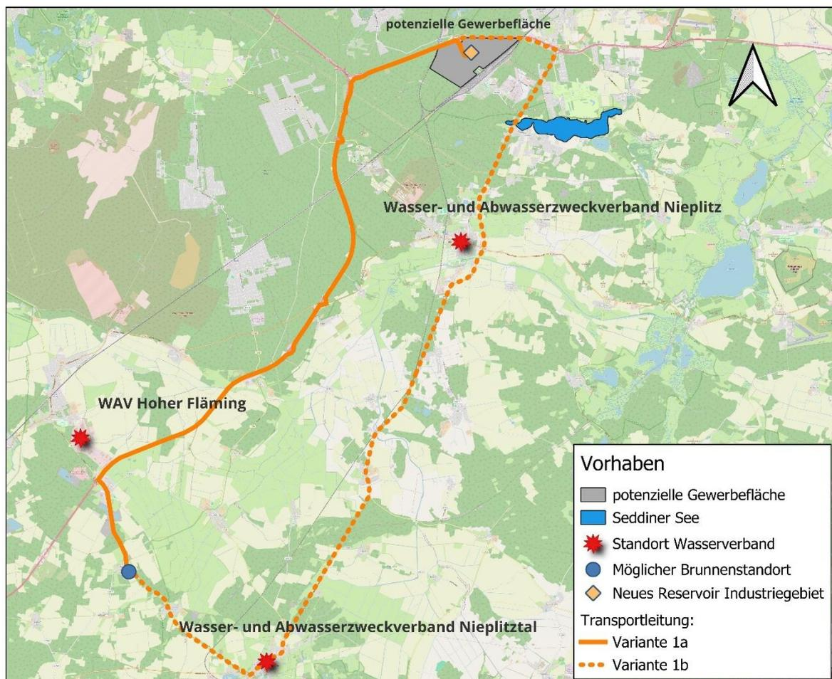
**Abbildung 11: Mögliche Trassenvarianten für die Wasserversorgung des Industriegebietes**
