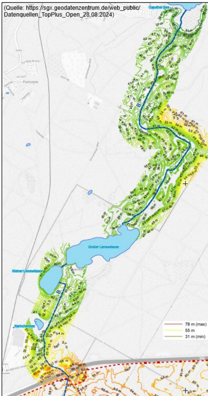
Als Leitungstrasse kann die vorhandene Autobahnunterführung der Kreisstraße K6907 verwendet werden. Diese wird als ausreichend groß dimensioniert eingeschätzt, um die Rohrleitung dort zu verlegen. Der weitere Verlauf folgt der vorhandenen Ortsstraße "Am Lienewitzsee" bis zum Ostufer des Kleinen Lienewitzsees.
