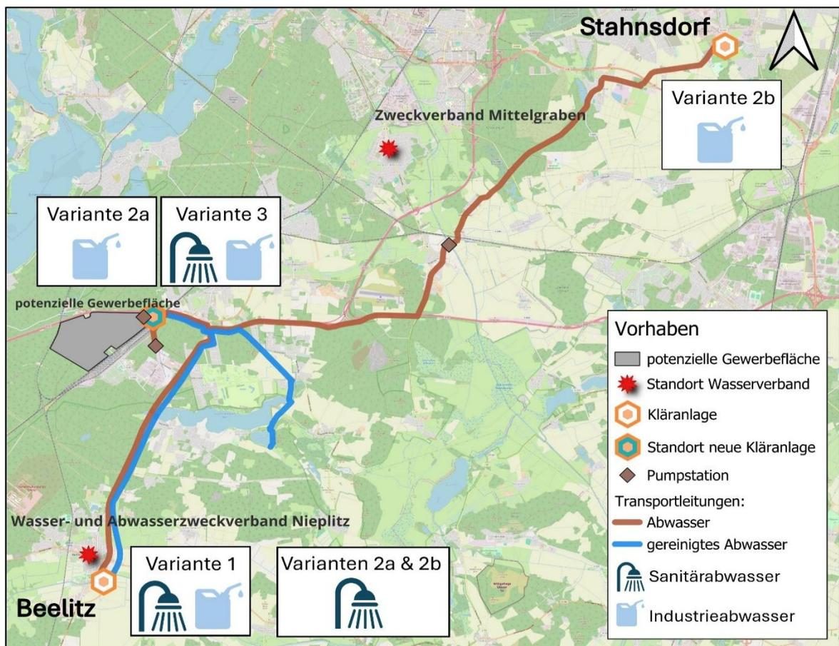
**Abbildung 13: Mögliche Trassenvarianten für die Schmutzwasserentsorgung des Industriegebietes**
